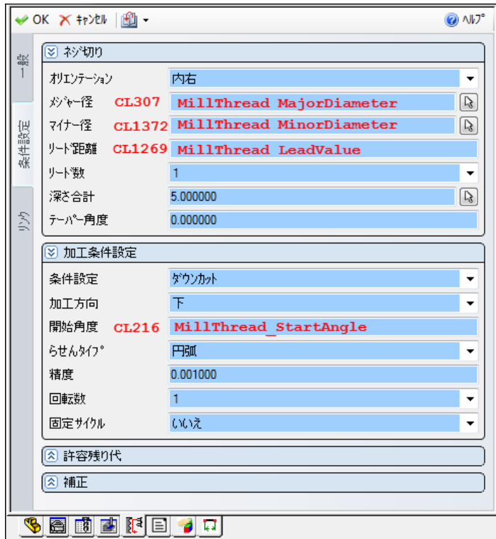
図 2. 新しいシステム変数はネジ切りミル加工に使用できます。
